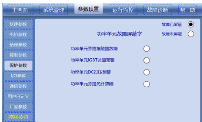
图7-66 功率单元故障屏蔽设置
