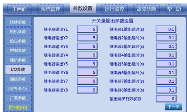
图7-73 开关量输出参数设置 1
