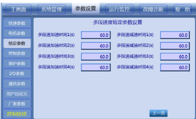
图7-71 多段速加减速时间设置画面
