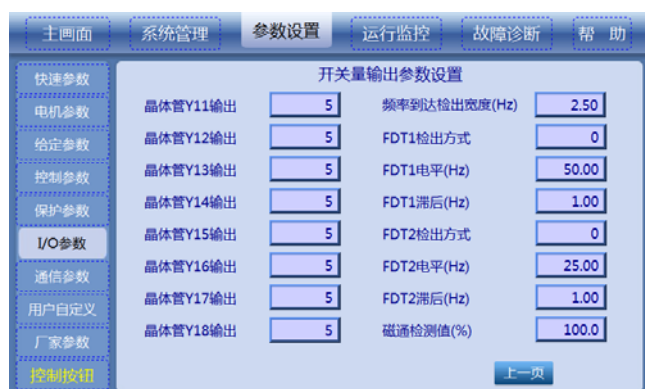
图7-74 开关量输出参数设置 2
