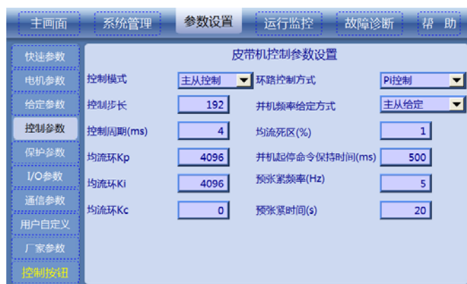
图11 皮带机控制设置页面
