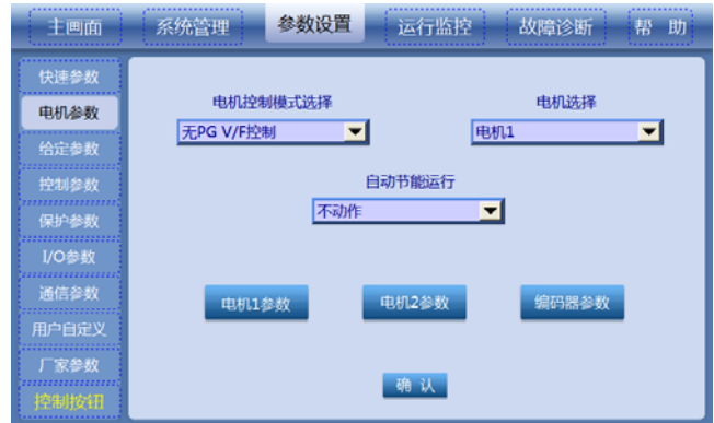
图7-7 电机控制参数
