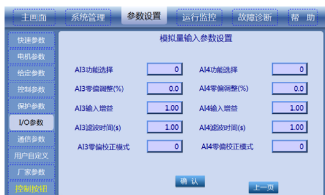
图7-79 模拟量输入参数设置 2
