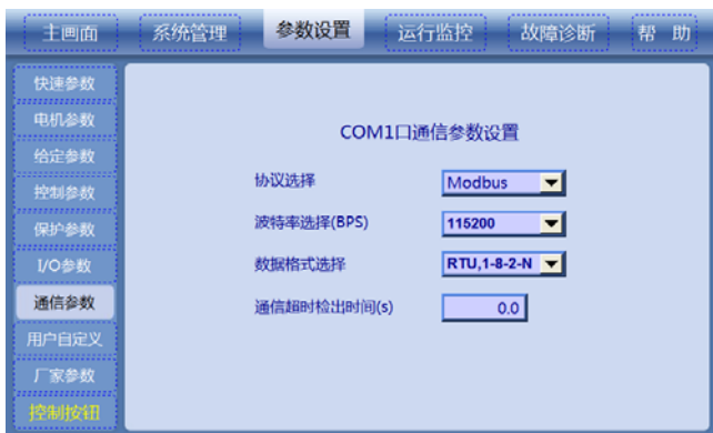
图7-90 COM1 口通信参数设置
