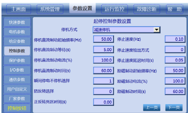
图7-41 起停控制参数设置 2
