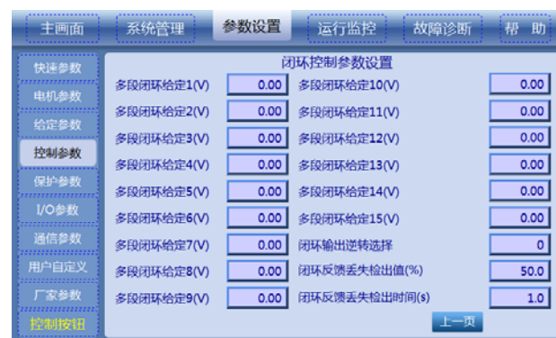
图7-53 闭环控制参数设置 2
