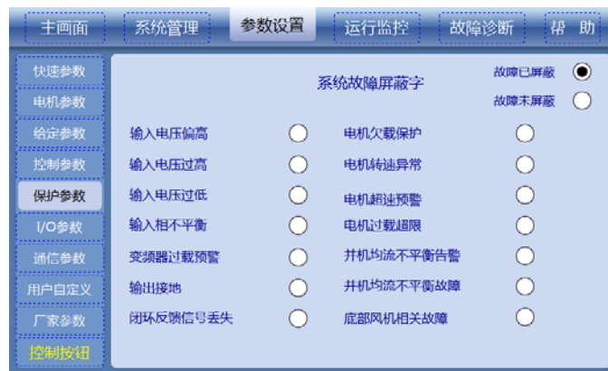
图5-16 系统故障屏蔽字画面
