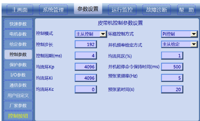
图7-61 皮带机控制参数设置画面
