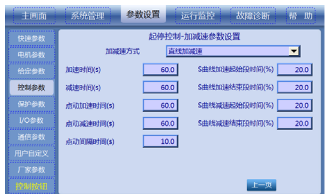
图7-46 起停控制参数设置 3
