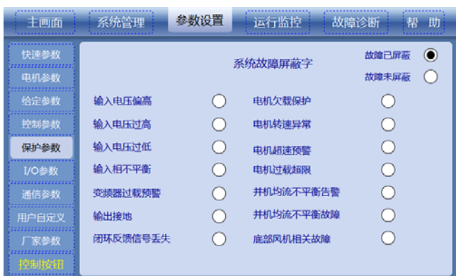
图7-65 系统故障屏蔽设置
