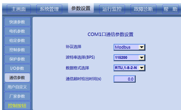
图5-20 COM1 口通信参数设置画面
