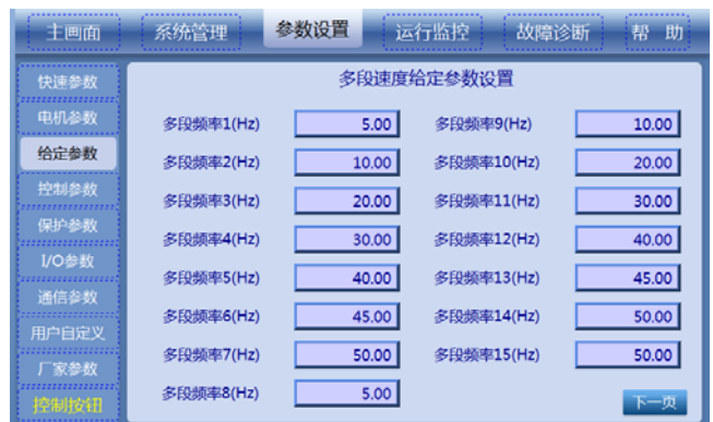
图7-23 多段速度给定参数设置
