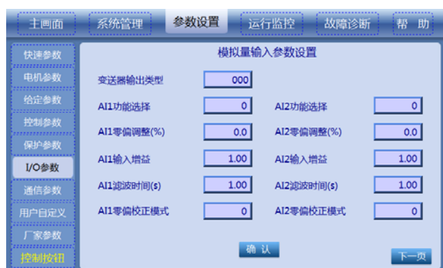
图7-78 模拟量输入参数设置 1
