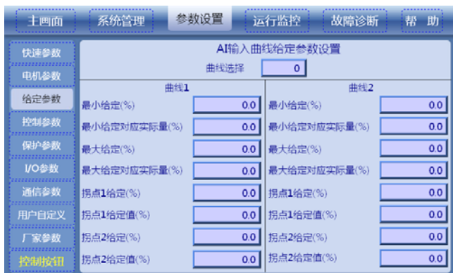
图7-24 AI输入曲线给定参数设置
