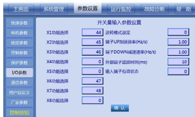
图5-18 开关量输入参数设置画面
