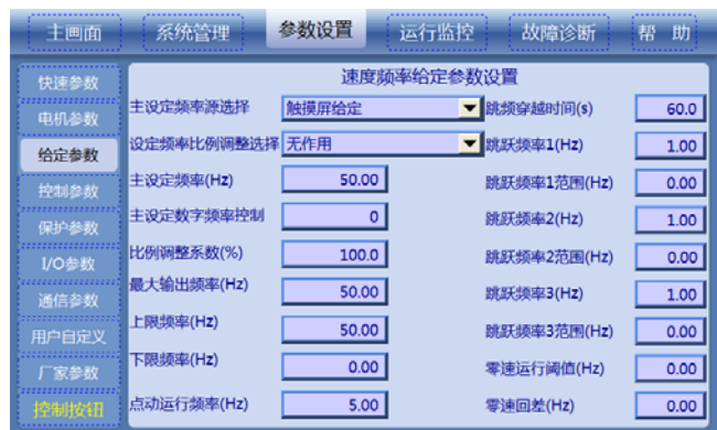
图7-19 速度频率给定参数画面
