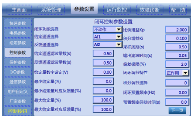
图7-52 闭环控制参数设置 1
